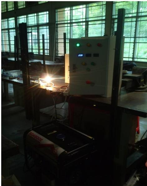
Gambar 10 Kondisi Pengujian Pada Saat Suplai Energi dari PLTS
